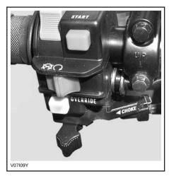
CHOKE LEVER IN THE FULL CHOKE POSITION
